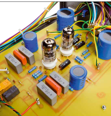
Für die Signalverarbeitung beider Kanäle braucht's nur zwei Röhren
