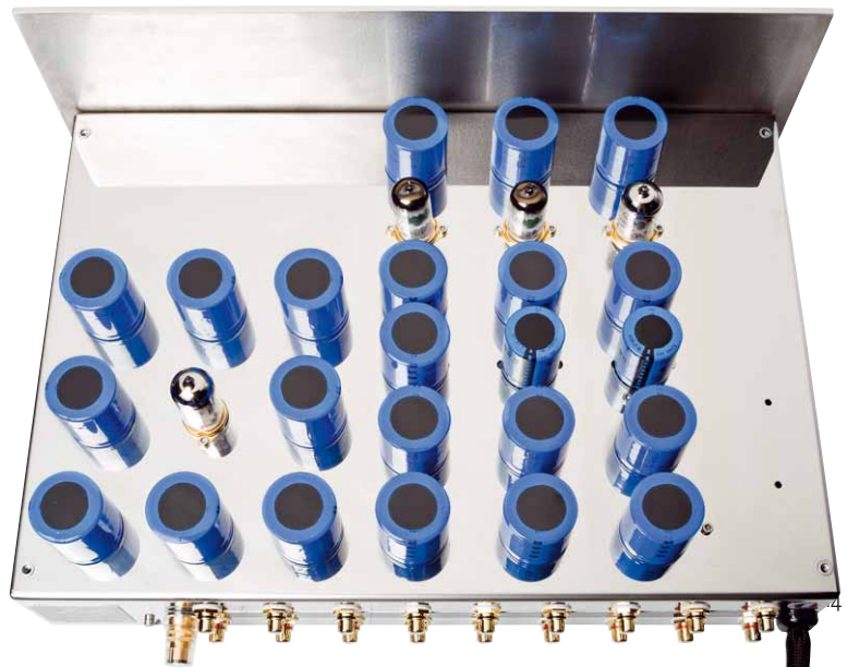
Eine ordentliche Anzahl von Elkos hilft beim Säubern der Betriebsspannungen
