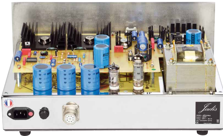
Die Versorgungseinheit zeigt nicht mit Aufwand, sie generiert ihre eigene Wechselspannung zur Speisung des Netzteils
