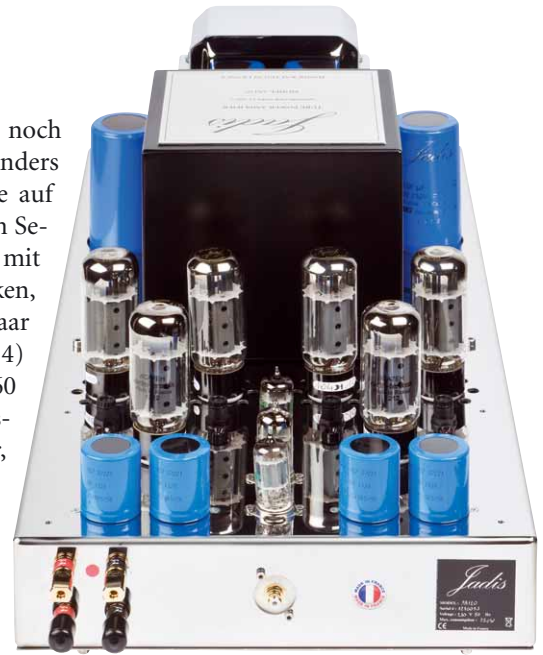
Unterm Gitter der JA120 versteckt sich eine illustre Runde aus neun Röhren
