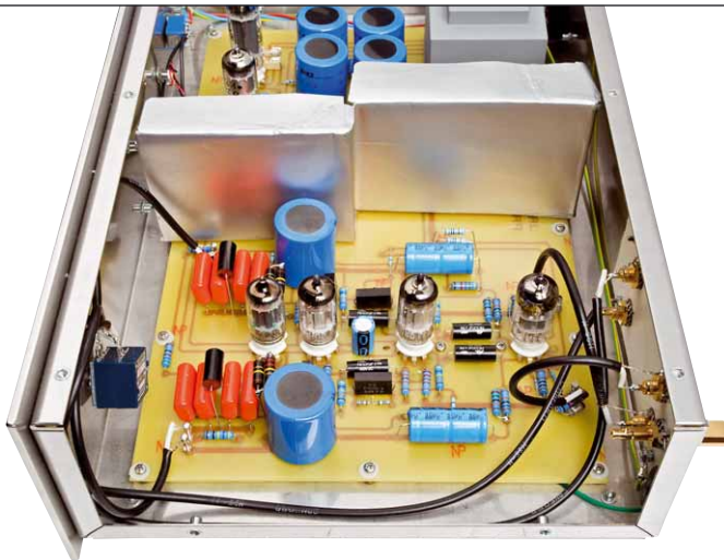
Die DPMC schafft 61 Dezibel Verstärkung nur mit vier Röhren, ganz ohne Übertrager – nicht schlecht
