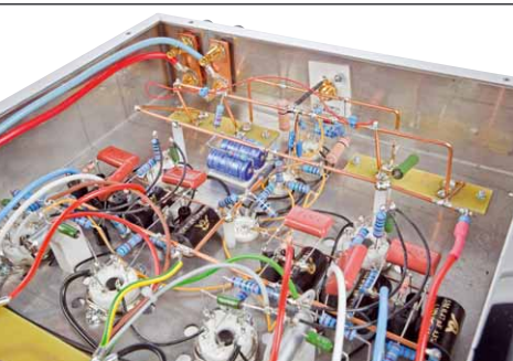
Mehrlagiger Aufbau: So baut man kompakt und elektrisch optimal, allerdings mit maximal viel Handarbeit
