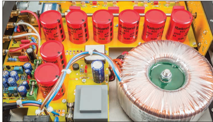
Ein mächtiger Ringkerntransformator und große Lade-Elkos sorgen für mehr als genug Stromlieferfähigkeit
