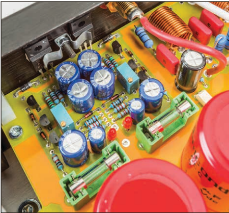
Das Netzteil besitzt getrennte Sektionen für die unterschiedlichen Baugruppen im Verstärker
