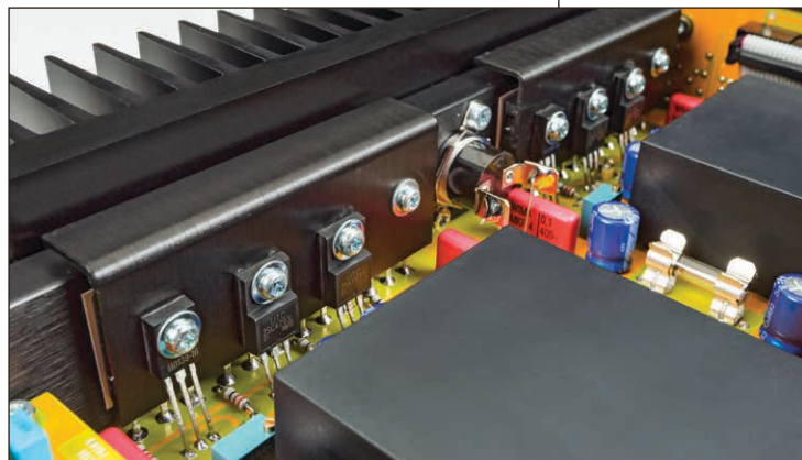
Drei MOS-Fet-Pärchen sorgen für die Ausgangsleistung von immerhin 140 Watt an 4 Ohm
