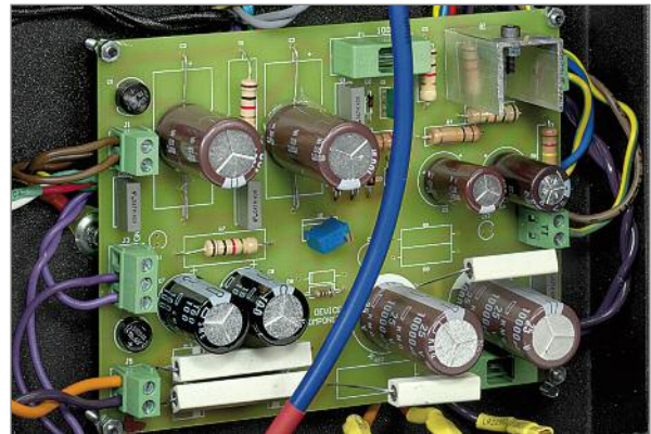
Links o.: Unter den Treiberröhren wird's eng für die Schaltung aus Widerständen und ausgesuchten Kondensatoren
